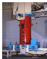
プルトニウム燃料製造施設の「非立合型非破壊検認装置」と「封じ込め・監視システム」
