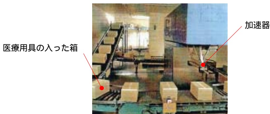
写真 8.1.2 電子加速器で医療用具を照射する装置
