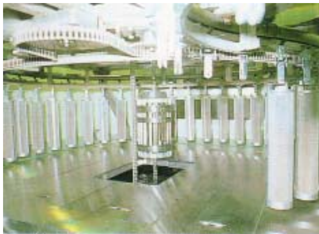
写真 8.3.1 ウリミバエのサナギに対するガンマ線照射施設(沖縄)
