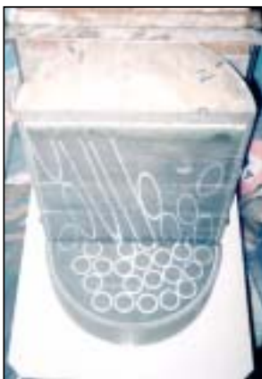
図 4.3.1.1 原子力発電所から発生する低レベル放射性廃棄物の例。金属配管を固めたセメント固化体（模擬）。ドラム缶内でセメント固化した後ドラム缶を剥ぎ取り、固化体を切断した断面。白く見えるのが金属配管
