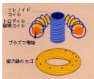
図 10.2.3 トカマクの原理図
