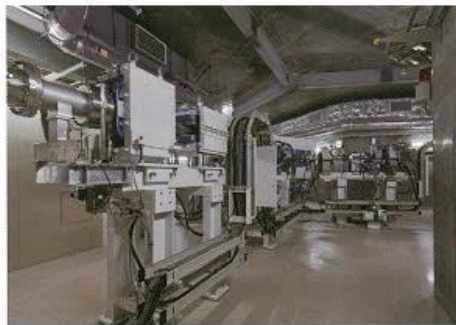
南東北 BNCT 研究センター陽子ビーム加速器と輸送装置
