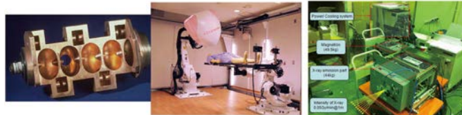
(c) 医療用・非破壊検査用Xバンド(9.3GHz)(左から加速管、6MeV、950keV)
