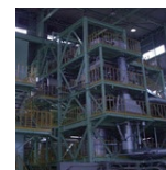
蒸気発生器安全性 総合試験装置 (SWAT-3R)
