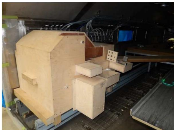
模擬アーム組み込み（根元部）
