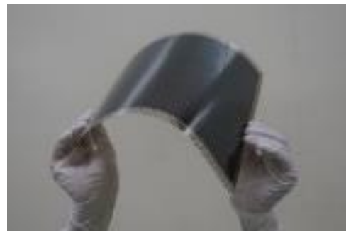
<フィルム基板へ形成したペロブスカイト太陽電池モジュール>
