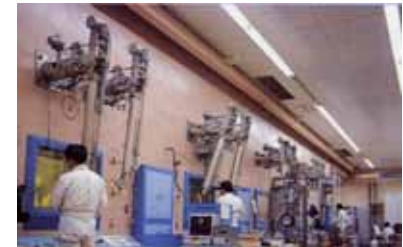
高速増殖炉燃料の照射後試験
