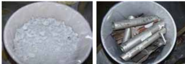
施設の解体で発生するコンクリート片・金属など
