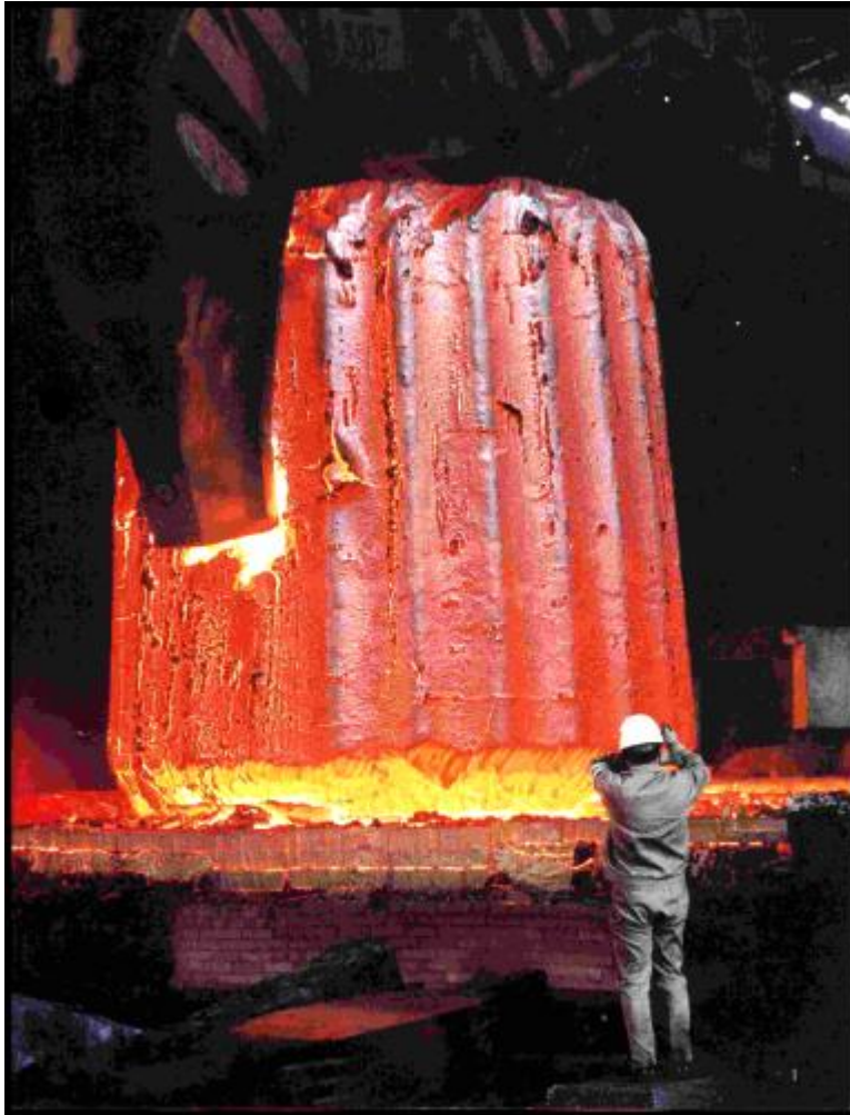
570t鋼塊の出炉
