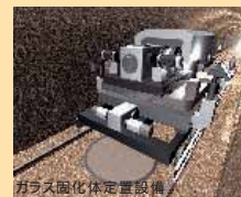
ガラス固化体定置設備
