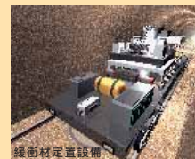
緩衝材定置設備
