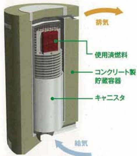
コンクリートキャスクの概要 使用済燃料を収納したキャニスタを円筒形のコンクリート製遮蔽構造物内に設置
