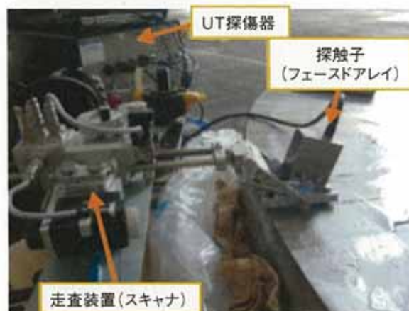
図3-2 PA法による自動UT検査装置の開発 1)
