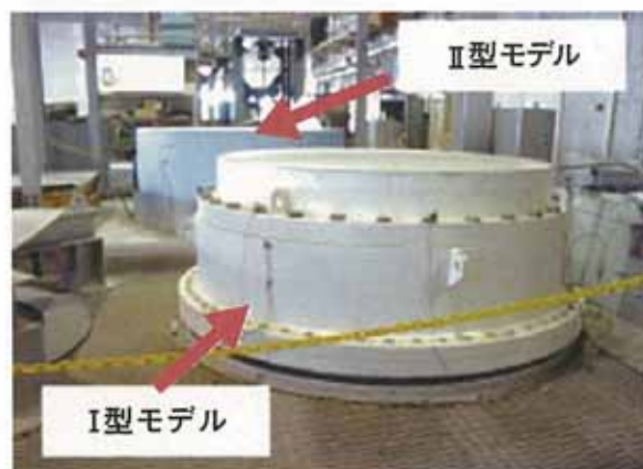
図2-6 長期密封試験の試験体
