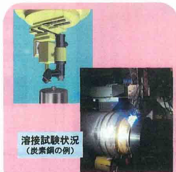
オーバーパックの遠隔溶接・検査技術
