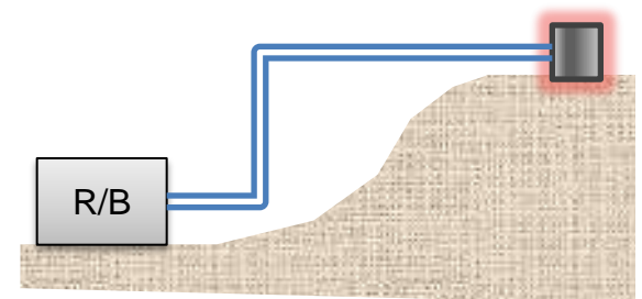
災害対策のための 発電機の配置場所
