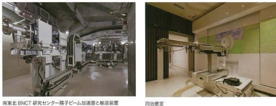
図 7-12 BNCT 治療システム (南東北 BNCT 研究センターの例)
