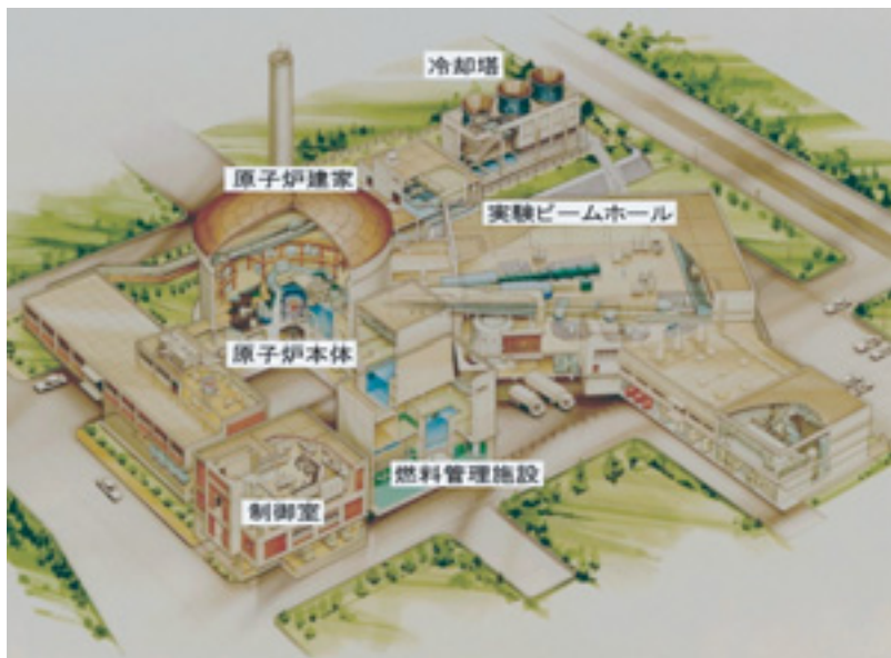
図4-1-3 改造により性能が向上したJRR-3Mの建屋(上)と炉室(下)
