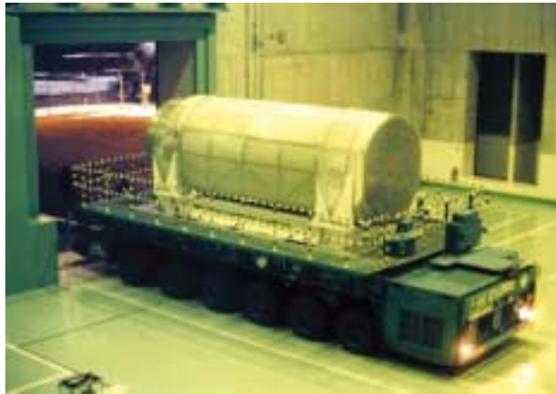
図2-3-31 ガラス固化体輸送容器（キャスク）
