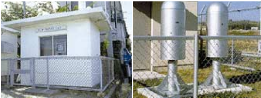
図2-2-7 モニタリングポスト(左)とモニタリングステーション(右)(放射線監視装置)
